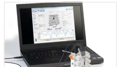
Arabirim Konfigürasyon Yazılımı, 750-923 USB Haberleşme Kablosu ile
