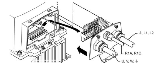
Per montaggio EMC, emissioni irradiate, secondo EN 55022 classe B:
