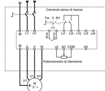
Attenzione: nella regolazione di base è configurato solo il senso di marcia FW.
