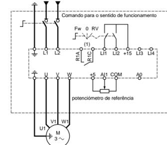
Atenção, para a regulação de fábrica apenas é válido o sentido de funcionamento FW.
