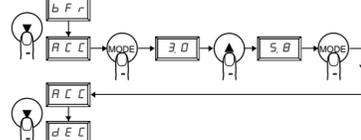
Parametri di livello 1: utilizzi standard
