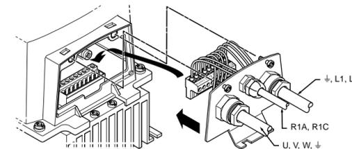
Zur EMV-gerechten Montage nach EN55022 Klasse B, abgestrahlte Störaussendung:
